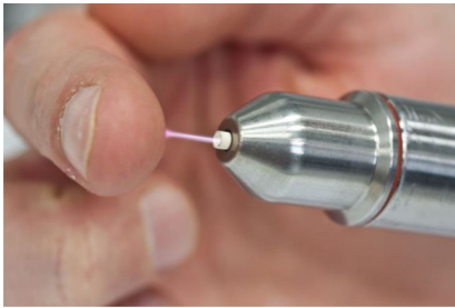
Abb. 3 ▲ Atmosphärendruck-Plasmajet kINPen® (INP Greifswald e. V./neoplas tools GmbH Greifswald). Aus der Spitze einer Kapillare tritt das Plasma aus und wird auf die zu behandelnde Fläche (Fingerkuppe) gerichtet
